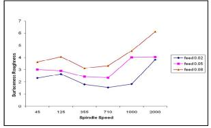
Fig 2 (d) – 10mm  $\phi$  Drill and different Feed Rates
